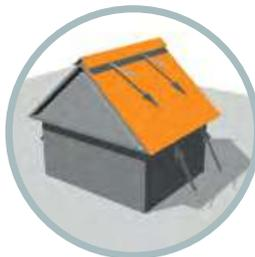
En la **cubierta microventilada** las tejas se fijan en seco, con tornillos, ganchos o clips, en lugar de con mortero y/o pastas. Esta fijación de las tejas se puede realizar tanto sobre soporte discontinuo (rastreles), como sobre soporte continuo (placas onduladas, etc.). Los accesorios necesarios para conseguir la ventilación bajo teja son suministrados por los propios fabricantes de teja cerámica.
