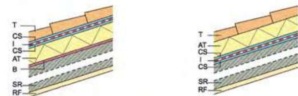
QB09: Inclinada, con soporte resistente inclinado, no ventilada, convencional e invertida, con tejado
